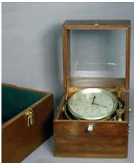
**72 - Chronomètre de marine.** Réserve de marche de 56 heures avec échappement à détente. Cadran argenté, numéroté 633 N sur le cadran des secondes, à 6 heures. Cuve en laiton montée à la cardan dans son coffret vitré doublé d'un coffret de transport.
